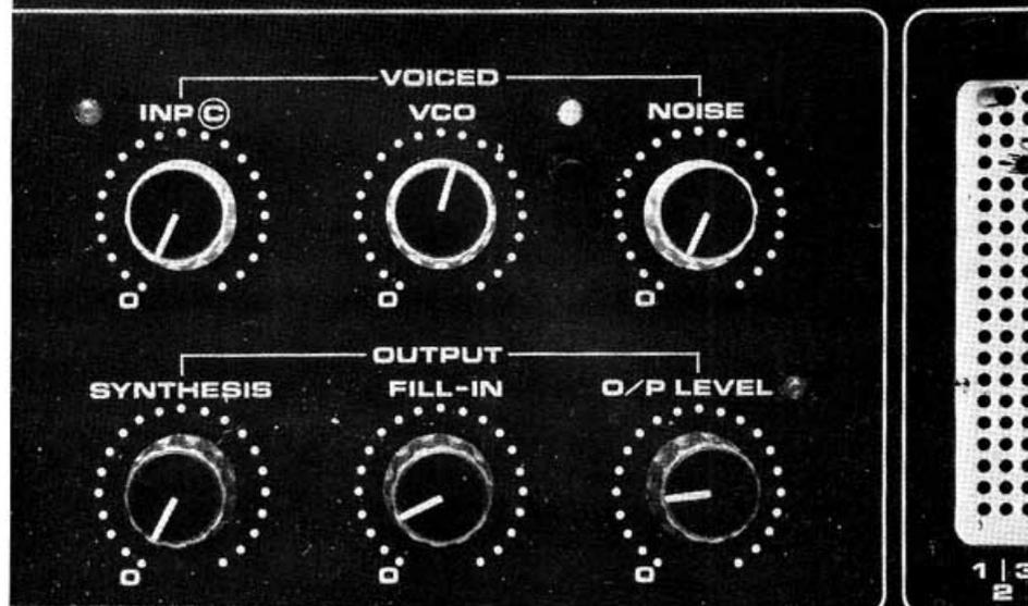
Les commandes et les sorties. Un bouton se cache sous la diode de droite, il met en service le système de remplacement des « unvoiced » pas du bruit.
